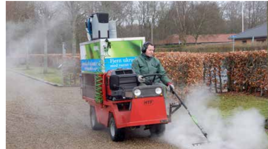
Temperaturen på det vand, der kommer ud af lansen skal være 98 grader varmt.
